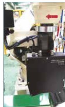
CO<sub>2</sub>溶接部位のビード形状を3Dレーザーセンサーで立体的に測定し、それぞれのプロファイルを分析して、溶接の長さ/幅などの外観測定、溶接の正常可否を判定するシステムです。
